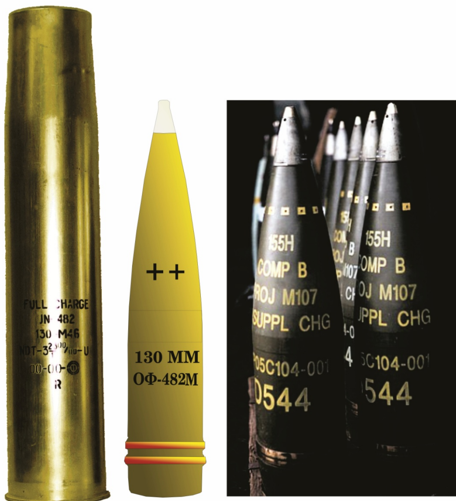
Слика 4.4 Пројектил 130 мм ОФ-482М упоређен са пројектилом 155мм М107. Овај последњи је еквивалентан пројектилу 152 мм и по калибру и по маси иако је калибар номинално различит јер постоје два начина мерења унутрашњег пречника цеви. Скалирани односи количина експлозива унутар граната 130 и 155мм су 1,25:1,00 и пројектил од 130мм се води као 30% убојно слабији у свим постојећим експертизама и упоредним табелама. Унутар М107 се налази 6,8 кг ТНТ а у новом типу исто толика маса али не ТНТ него новог експлозива чија је моћ (NEQ- Net Explosive Quantity) 1,75 пута већа као, сада уосталом и код пројектила 152 мм ОФ540.
