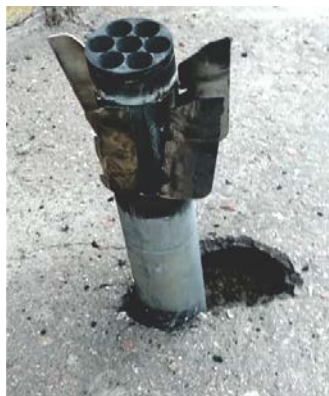
Слика 4.11. Неексплодирани пројектил система Град забијен у тло, долетео на циљ са максималним падним углом, при таном слоју уличног асфалта
